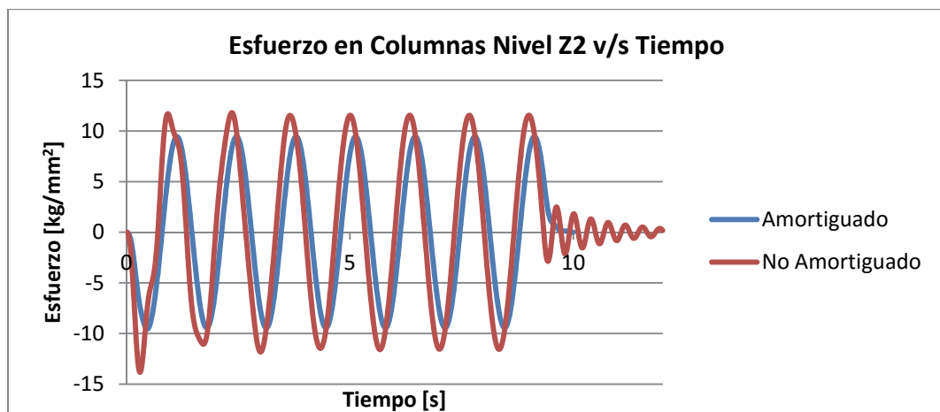
Figura 13. Esfuerzo en columnas v/s tiempo, carga MOV.
